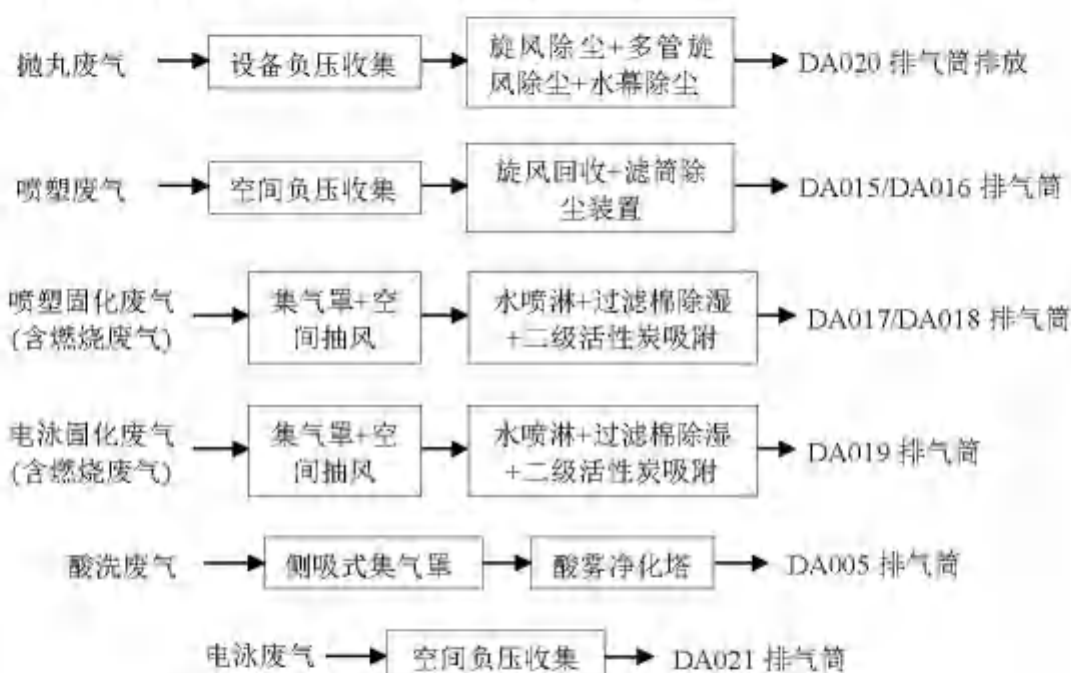
图 4-1 技改项目有组织废气污染治理流程示意图
