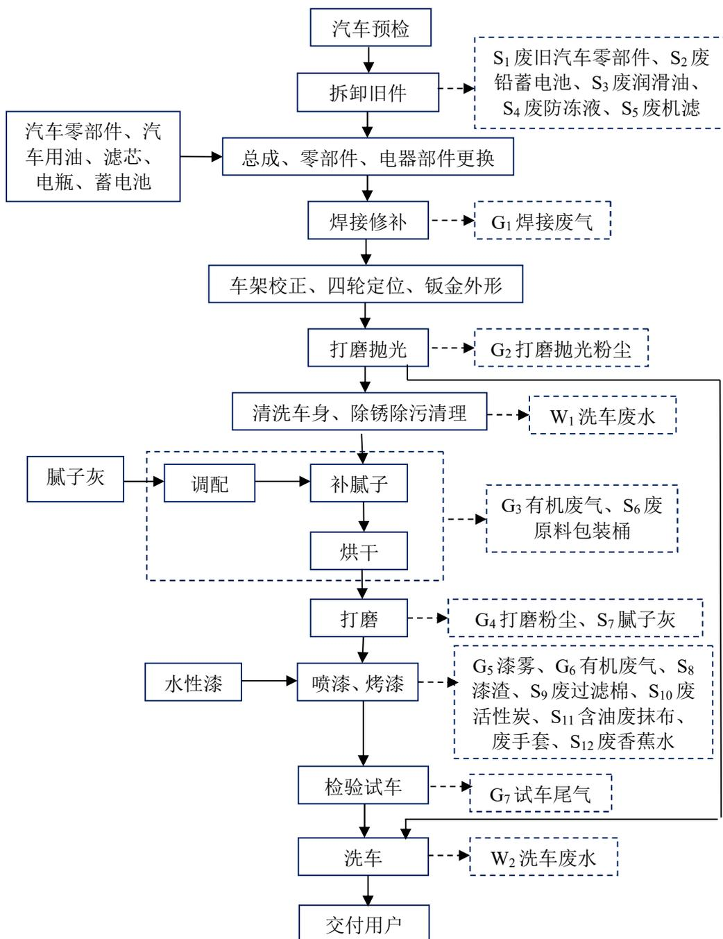
图 3.4-1 验收项目工艺流程及产污环节图
