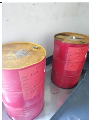
张贴危险废物标签及内部托盘
